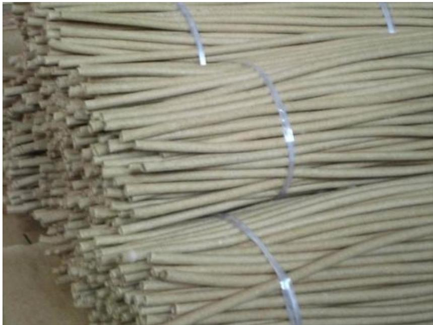
影响绝缘皱纹纸的三大性能指标绝缘纸这一系列的绝缘材料能起到很好的绝缘功效，但有时红色绝缘纸绝缘性能不太好，这个是什么引起的呢？1、绝缘电阻和电阻率：电阻是电导的倒数，电阻率是单位体积内的电阻2、相对介电常数和介质损耗角正切。3、击穿电压和电气强度：在某一个强电场下绝缘材料发生破坏，失去绝缘性能变为导电状态，称为击穿。击穿时的电压称为击穿电压（介电强度）。电气强度是在规定条件下发生击穿时电压与承受外施电压的两电极间距离之商，也就是单位厚度所承受的击穿电压。对于绝缘材料而言，一般其击穿电压、电气强度的值越高越好。绝缘材料是什么？电工常用的绝缘材料按其化学性质不同，可分为无机绝缘材料、有机绝缘材料和混合绝缘材料。常用的无机绝缘材料有：云母、石棉、大理石、瓷器、玻璃、硫黄等，主要用作电机、电器的绕组绝缘、开关的底板和绝缘子等。有机绝缘材料有：虫胶、树脂、橡胶、棉纱、纸、麻、人造丝等，大多用以制造绝缘漆，绕组导线的被覆绝缘物等。混合绝缘材料为由以上两种材料经过加工制成的各种成型绝缘材料。
